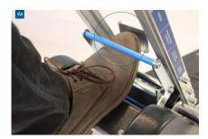
Pousser vers l'avant l'éclisse de sécurité avec le pied (photo 4a) puis tirer le levier vers l'arrière jusqu'à la butée (photo 4b).
