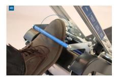
Поверните рукоятку вперед по направлению движения и слегка потяните ее наверх. При достижении положения зацепления рукоятка автоматически отсоединяется от основного блока.
