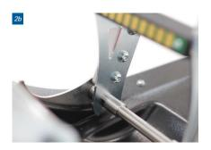
Убедитесь, что поперечины полностью входят в выфрезерованные пазы опорной планки (рис. 2b). Процесс зацепления облегчается поворотом рукоятки (вперед/назад).
