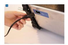
LIFTKAR PTR оснащен встроенным зарядным устройством аккумуляторной батареи. Светодиодный индикатор, расположенный на левой боковой панели устройства (рис. 16), показывает состояние зарядки во время процесса зарядки:
