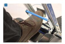
Сдвиньте ногой предохранительный выступ вперед (рис. 4a), а затем потяните фиксирующий рычаг в нижнее (заднее) крайнее положение (рис. 4b).
