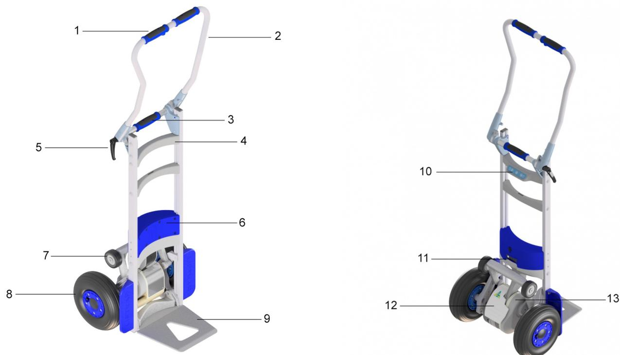
1: Touche montée - 2: Poignée supérieure - 3: Poignée tube transversal - 4: Cadre - 5: Levier de tension - 6: Batterie à changement rapide - 7: Bielette - 8: Roues principales - 9: Bavette - 10: Unité de commande - 11: Affichage du niveau de charge - 12: Volet de sécurité - 13: Unité de levage
