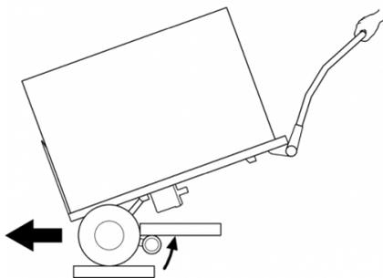
En condition normale d'utilisation, avec une charge bien équilibrée, le bras support se trouve toujours éloigné du dessous de la marche supérieure (chapitre 4.2). Si le LIFTKAR est trop basculé vers l'arrière, le bras support va buter sous la marche qui le surplombe. Les commandes électro-niques vont se mettre en mode surcharge et devront être réinitialisées.
