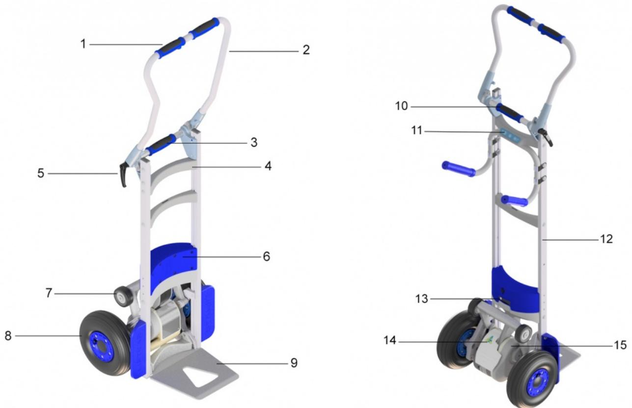
1: Touche montée - 2: Poignée supérieure - 3: Cadre - 4: Levier de tension - 5: Poignée inférieure - 6: Batterie à changement rapide - 7: Bielette - 8: Roues principales - 9: Bavette - 10: Poignée tube transversal - 11: Unité de commande - 12: Cadre - 13: Affichage du niveau de charge - 14: Volet de sécurité - 15: Unité de levage
