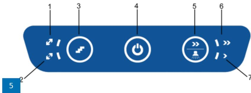
1: Modalidad continua - 2: Modalidad de escalón por escalón - 3: Interruptor de modalidad continua o de escalón por escalón - 4: Interruptor de encendido y apagado/indicador de estado - 5: Interruptor de velocidad/luz de escalera - 6: Indicador de velocidad rápida - 7: Indicador de velocidad lenta
