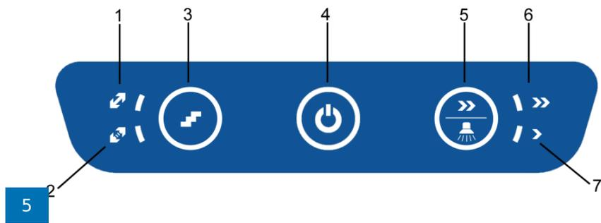
1: Многоступенчатый режим - 2: Одноступенчатый режим - 3: Кнопка одноступенчатого/многоступенчатого режима - 4: Кнопка ВКЛ/ВЫКЛ / индикация состояния - 5: Кнопка регулировки скорости / лестничное освещение - 6: Индикация быстрой скорости - 7: Индикация медленной скорости
