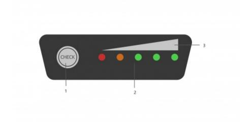
1: Tecla de activación indicador del nivel de carga - 2: Pantalla LED - 3: Visualización
