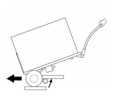
En condiciones normales de funcionamiento, con la carga en posición bien equilibrada, el brazo móvil de apoyo queda libre de la parte inferior del escalón superior (capítulo 4.2). Si la LIFTKAR está demasiado alejada, el brazo de apoyo tropezará al tocar el escalón lo que hará que gire bajo el escalón superior. El sistema electrónico pasará a modo sobrecarga y necesitará ser reajustado.
