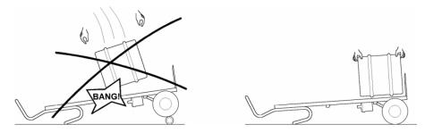
Dans l'industrie de la boisson, il arrive que des fûts soient directement jetés du camion sur le diable, au lieu d'un coussin ou d'un vieux pneu.
