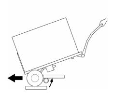
En condition normale d'utilisation, avec une charge bien équilibrée, le bras support se trouve toujours éloigné du dessous de la marche supérieure (chapitre 4.2). Si le LIFTKAR est trop basculé vers l'arrière, le bras support va buter sous la marche qui le surplombe. Les commandes électro-niques vont se mettre en mode surcharge et devront être réinitialisées.
