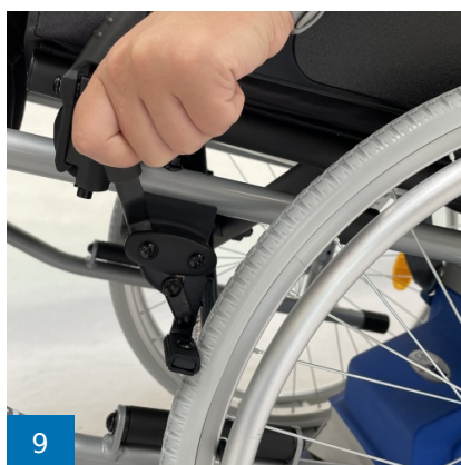
9 Räder des Rollstuhls einbremsen
