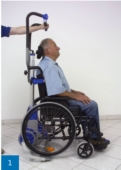
1 Treppensteiger nach vorne kippen, bis Lenkrollen des Rollstuhls am Boden stehen
