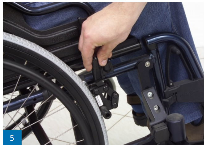
5 Bremsen lösen und wegfahren
