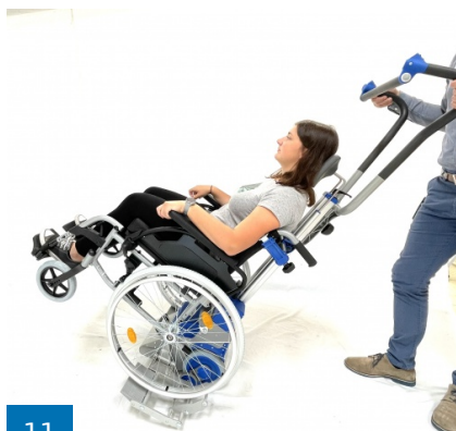
11 PT zurück kippen (bis ins Gleichgewicht) danach losfahren
