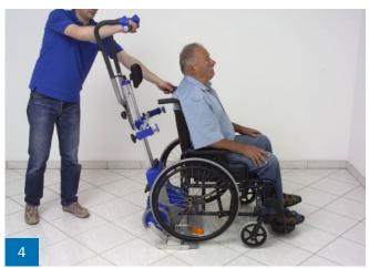
Inclinar el PT hacia atrás hasta que se pose en el suelo
