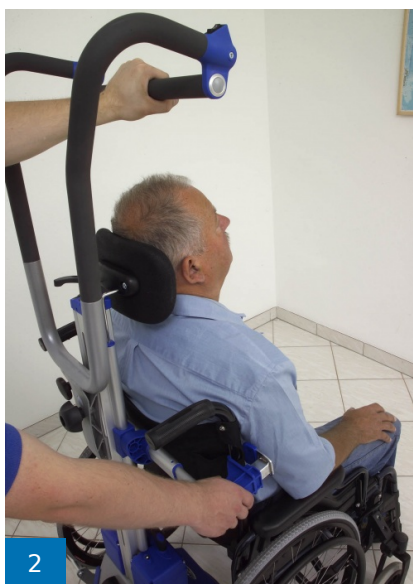
2 Con una mano empujar el PT hacia adelante, con la otra soltar la abrazadera en un lado
