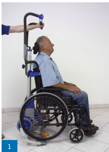
1 Inclinar el PT hasta que las ruedas delanteras de la silla toquen el suelo
