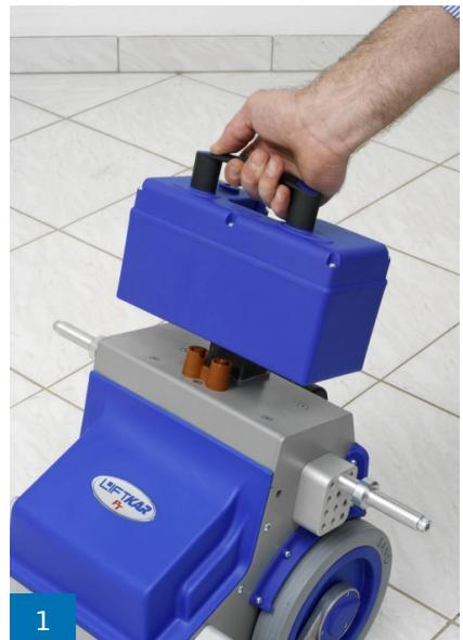
2. Umetnute stupac jedinice ručke u udubljenje za akumulator ([slika 2](#)) i na montažnu utičnicu.
