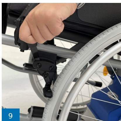
9 Kotače kolica zakočiti
