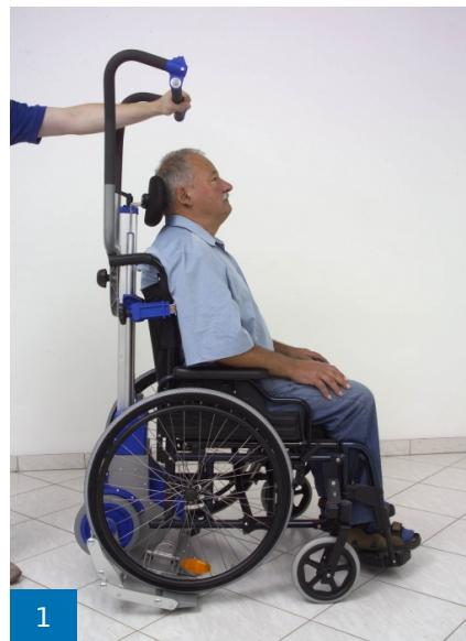
Nagnite PT prema naprijed dok prednji kotači invalidskih kolica ne dodirnu tlo
