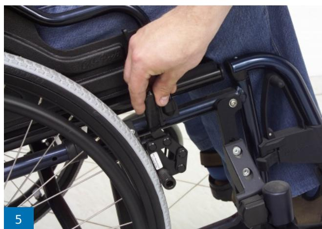
Otpustite kočnice invalidskih kolica i krenite dalje bez PV
