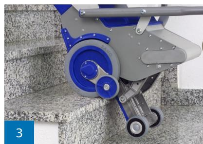
5. Pomičite se postupno prema naprijed do ruba stepenice dok rubna kočnica automatski ne zaustavi glavne kotače na Liftkar PT ([slika 3](#)). Sada pritisnite Prekidač gore/dolje (strelica prema naprijed). Pobrinite se da imate jednu ruku na gredi, a da je druga slobodna za upravljanje prekidačem. (Vi samo trebate pritisnuti jedan od prekidača.)
