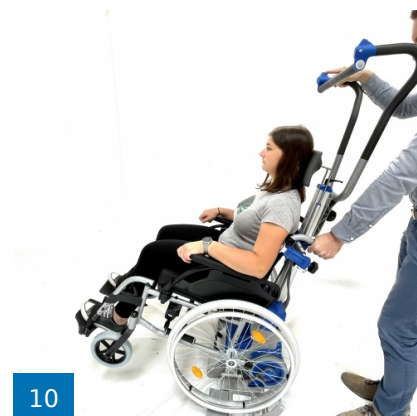
10 Wciągnąć wózek inwalidzki obiema rękami na wysięgniki; w miarę możliwości osoba siedząca na wózku może pomóc.
