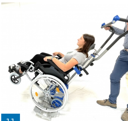
11 Odchylić PT do tyłu (aby osiągnąć równowagę) i ruszyć.
