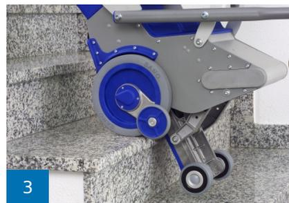
5. Постепенно перемещайте подъемник к краю ступени, тормоз автоматически остановит ходовые колеса подъемника (Рис. 3). Нажмите на переключателе рукоятки «Вверх/вниз» клавишу «Вниз».
