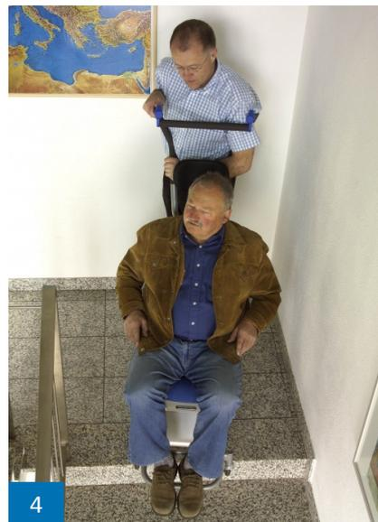
8. Повторяя вышеописанный процесс, поднимите устройство на следующую ступень.
