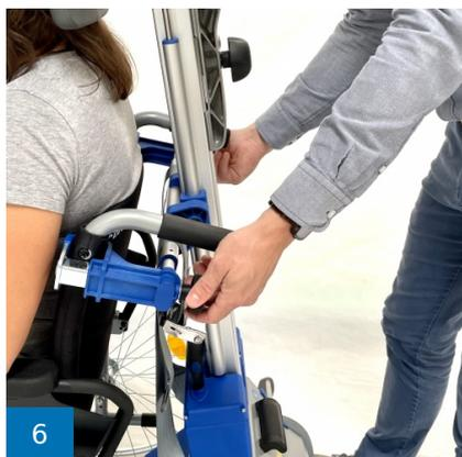
6 Наденьте зажим на спинку кресла с обеих сторон и слегка зафиксируйте его с помощью поворотной ручки
