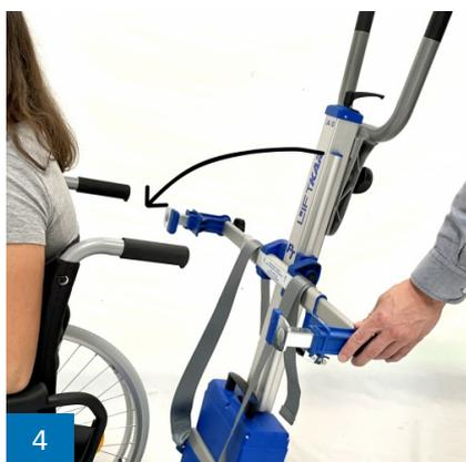
Потяните зажимы в сторону. Наклоните подъемник вперед, чтобы можно было закрепить зажим.
