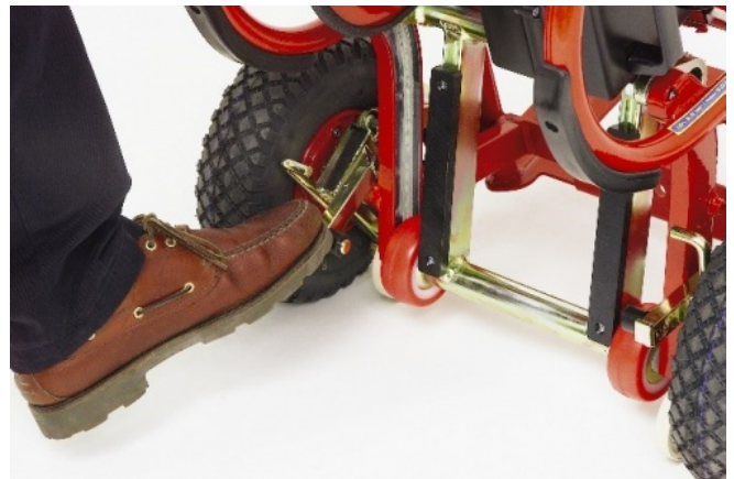
Mit dem Fuß weiter drehen bis zum Neutralstand.
