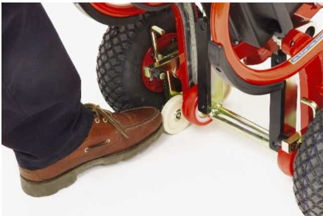
Hinteres Laufrad der Bremse nach vorne drücken
