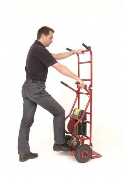
Para levantar cargas pesadas con menos esfuerzo, coloque el pie sobre el eje de las ruedas de apoyo desplazado hacia atrás.
