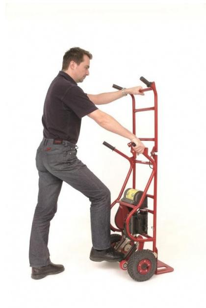
Za lakše podizanje teških tereta, stavite nogu na osovinu potpornog kotača izvučenu prema nazad!
