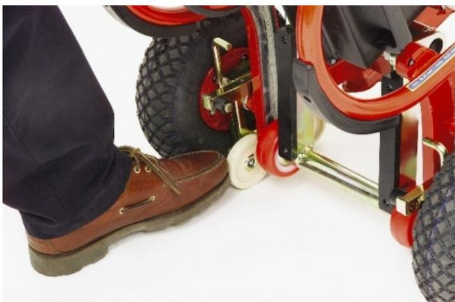
Gurnite stražnji kotač kočnice prema naprijed
