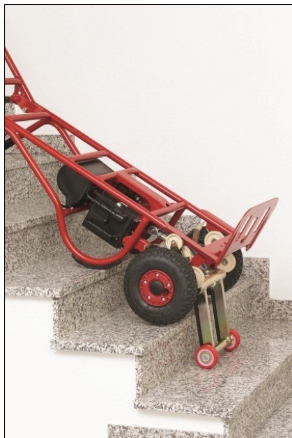
Posizione di sosta sul gradino.
